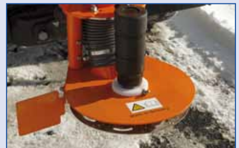
Höhenjustierbarer Streuteller mit Aufgabepunkt- sowie Wurf-schaufelverstellung
